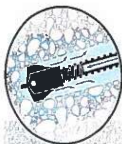
Директно сондиране с вращателна суспензия до основата на пробивния отвор
