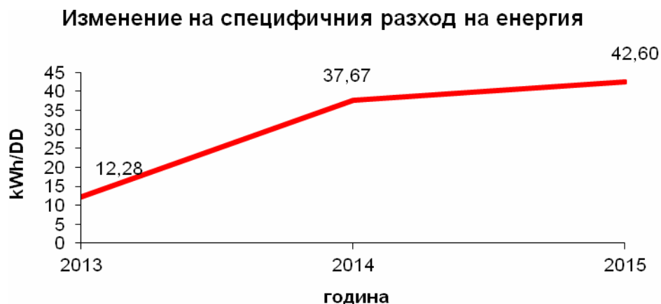
Фиг. 9. Изменение на специфичния разход на енергия от 2013 до 2015 г. Приетата е 2015 г. за калибриране на модела на енергопотребление в сградата, поради най-голям специфичен разход на енергия, поради най-висок специфичен разход на енергия.
